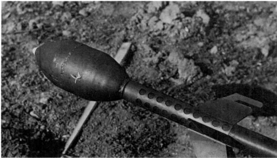
BILD 126 6 kg-Wurfmine mit Verzögerungszünder, aufgeschoben auf das Rohr eines 3.7 cm-Pak-Geschützes. Schon ein geringfügiges Verbiegen des Blech-Leitwerks änderte die Flugrichtung um mehrere Meter!
