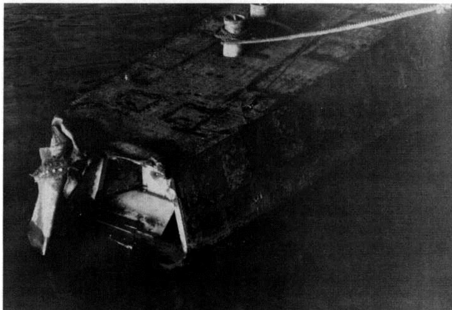
4 Beim zweiten Rammstoss wurden zweieinhalb Meter vom Heck des Boots abgeschnitten.
