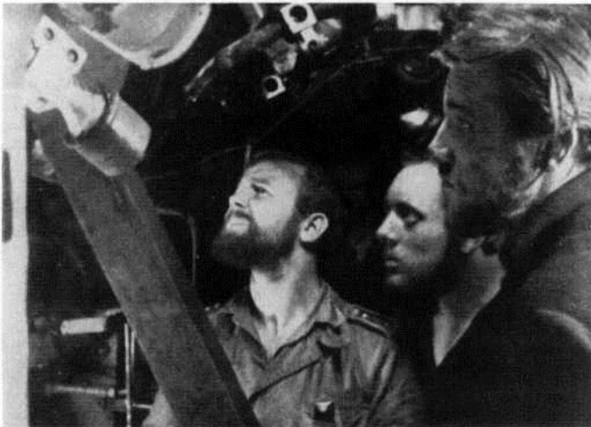
53 Durch die Was- serbomben hat sich der Diesel vom Sockel gelöst. Er wurde durch Balken provisorisch abgestützt.
