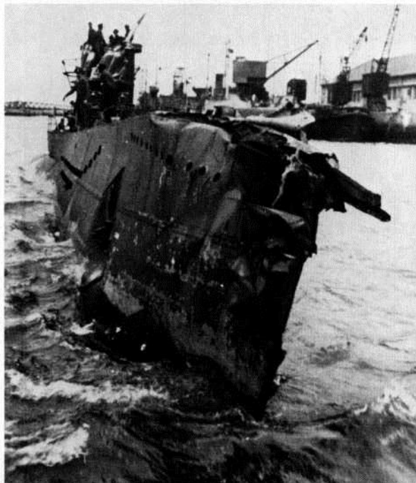
32 Durch Fliegerbomben, Rammen und Wasserbomben beschädigt . . .
