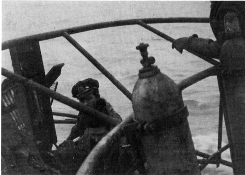
61 Diese Gasflaschen dienen zum Auffüllen der «Aphroditen». Dies waren Ballons mit Stanniolpapier, die ein falsches Echo für Radargeräte erzeugten.
