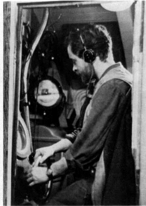
47 Im Funkraum: Die Zerstörergeräusche werden am Horchgerät abgehört, um Abwehrmassnahmen einleiten zu können bzw. die Position eines Geleitzuges festzustellen.
