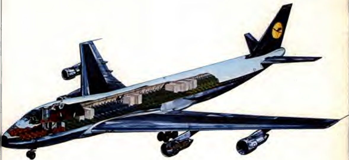
Ein Düsen-Passagierflugzeug unserer Tage (Schnitt durch einen „Jumbo-Jet“)
