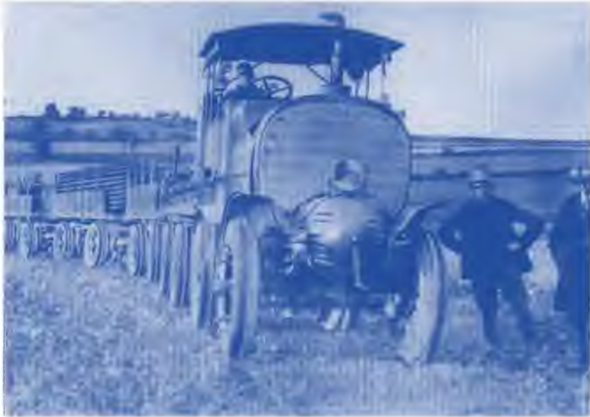
«Eisenbahn ohne Schienen»: Der von Porsche konstruierte und im Ersten Weltkrieg eingesetzte «Landwehr-Train»
