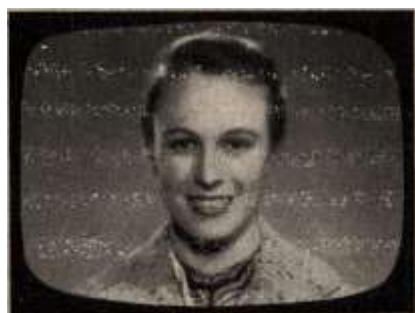
Abb. 11 Störungen durch Zündfunken oder Motore (Staubsauger etc.)
